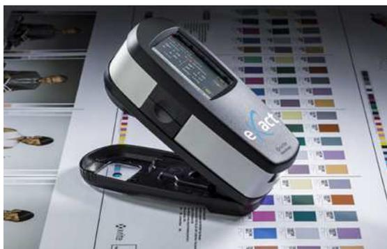
Der Marabu-ColorFormulator MCF-HD2 ist ein neues, mobiles Spektralphotometer mit modernster Technologie. Das Messgerät wurde von unserem langjährigen Partner X-Rite, dem Marktführer im Bereich der Farbmesstechnik für Druckfarben, unter dem Namen „eXact“ entwickelt. Es ist Spektralphotometer und Densitometer in einem und somit das ideale Instrument für Farbzuordnung, Qualitätskontrolle und Dichtemessung.
