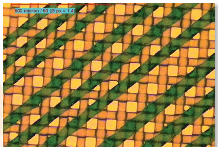
Winkellinien, Gewebe 120-34 Y, 320-fache Vergrößerung
