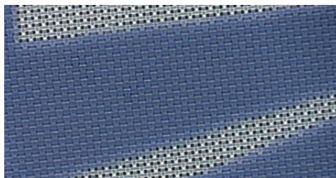
AZOCOL® Z 110 CTS Violet: Gewebe 120-34 W, Beschichtung 1D-1R, EOM 7 µm, Rz-Wert 10 µm, Vergrößerung: 100-fach
